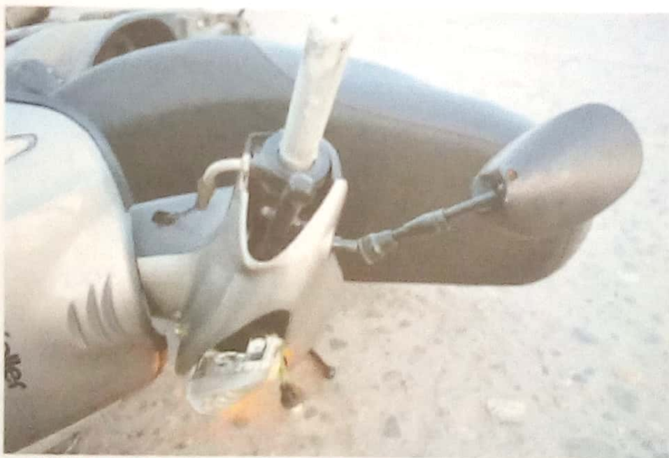
Fotografía N° 19: En detalle a óptica, se observan daños en guiño, manopla y espejo.
