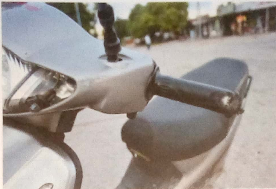
Fotografía N°36: En detalle a manopla izquierda se observa raspado.
