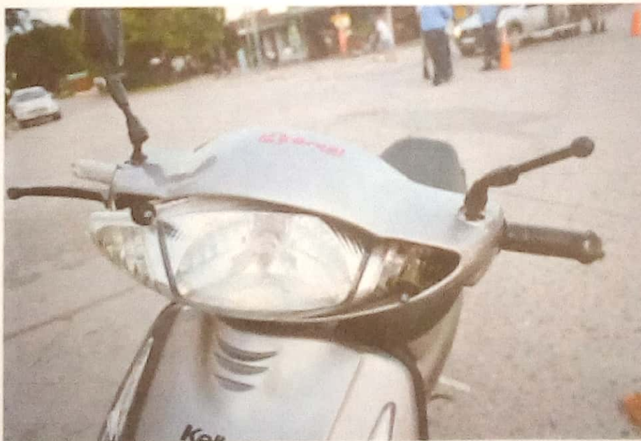
Fotografía N°37: En detalle a óptica se observan daños.
