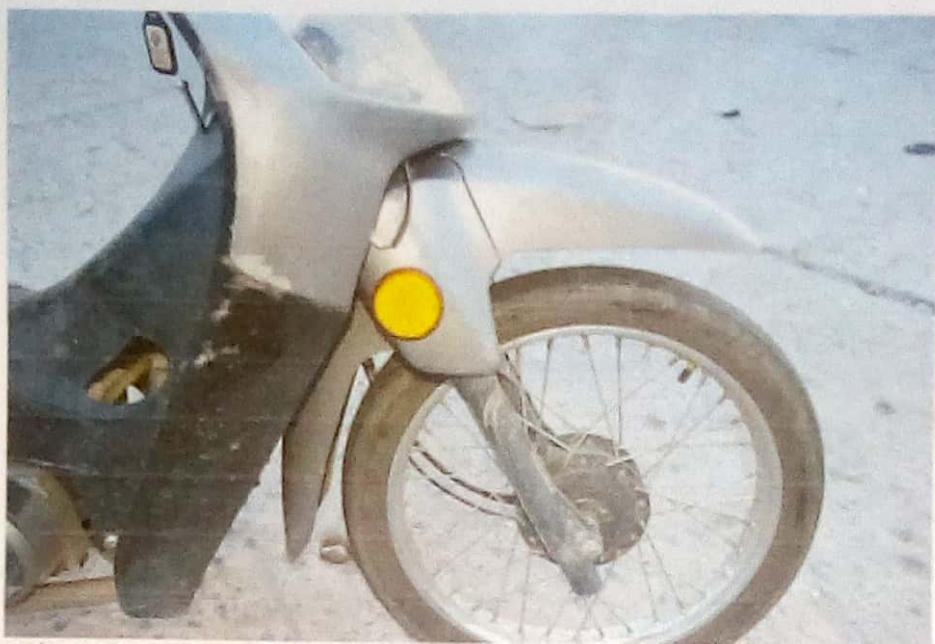
Fotografía N°38: En aproximación lateral derecho parte delantera, se observan daños en guño
