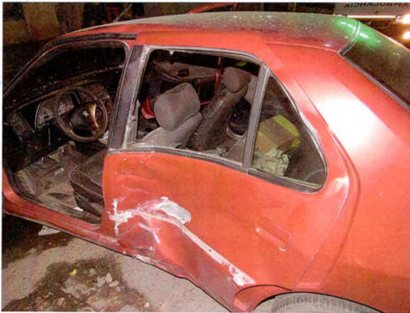
FOTOGRAFÍA N° 15: Vista más en aproximación hacia la puerta trasera izquierda, visualizándose hundimiento en el chasis, como así también daños en la pintura.
