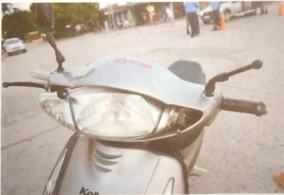
Fotografía N°37: En detalle a óptica se observan daños.
