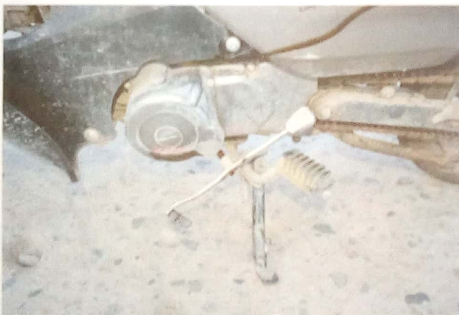
Fotografía N°33 En detalle a lateral izquierdo de motor, se observa posapiés y palanca de cambios dañada.
