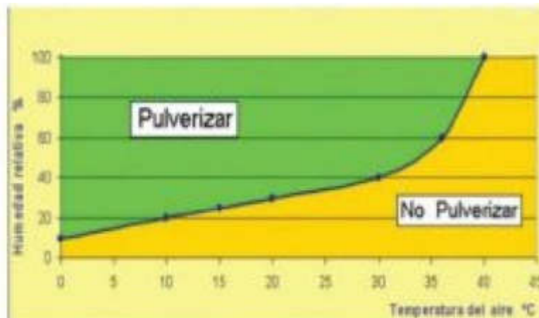
Figura 2. Combinación de temperaturas y humedades para determinar la oportunidad para realizar la pulverización (Etiennot, 2010).
