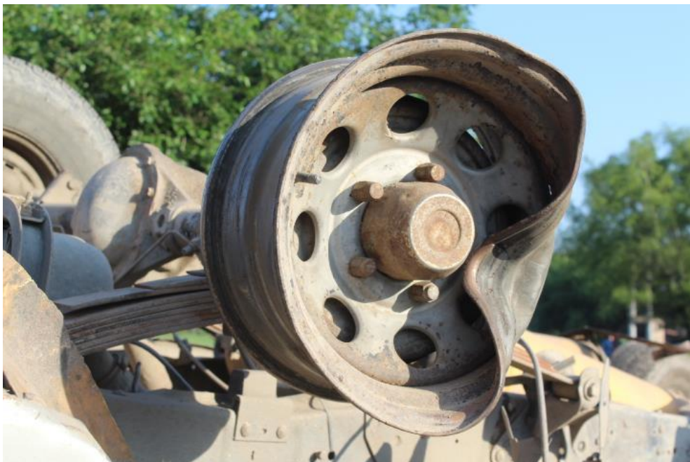
Toma en Detalle, obsérvese llanta trasera dañada. -
