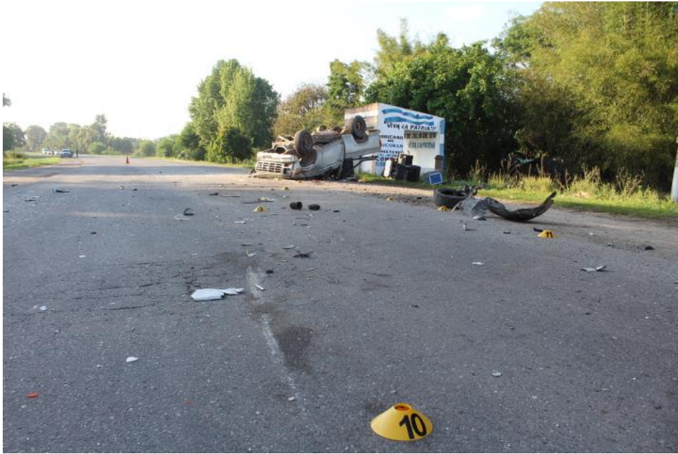
Toma en Aproximación donde se observa Fricción, mancha oscura y restos plásticos ubicados sobre carril Sur. -
