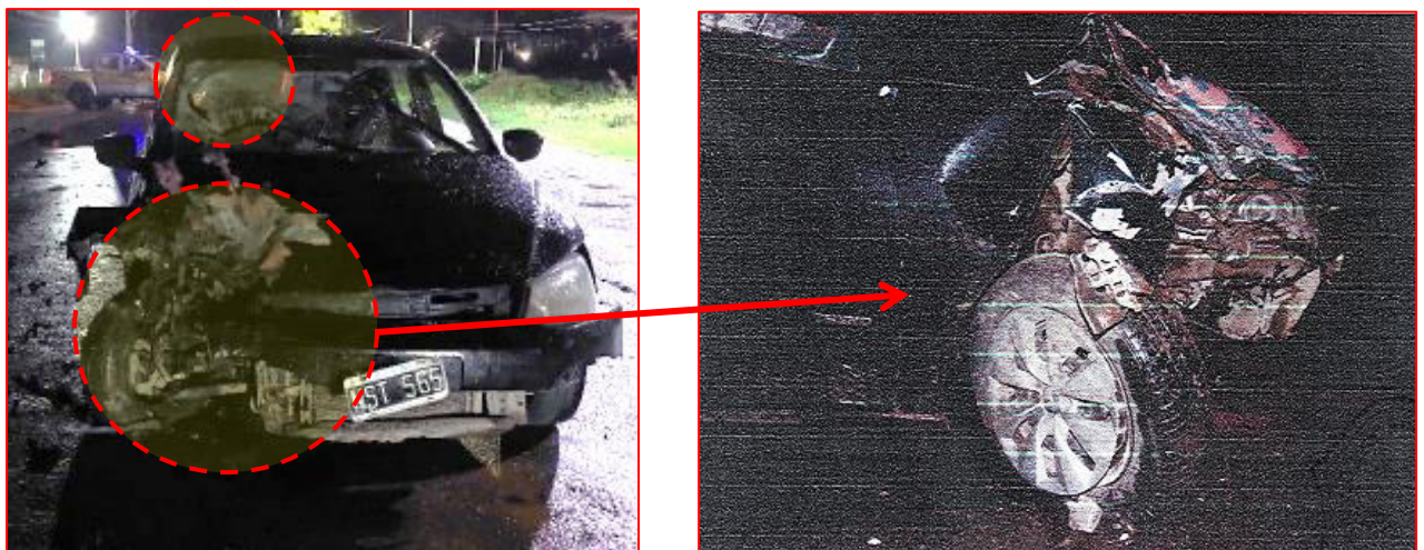
IMGAEN DIGITAL 06 Y 07 – VISTA GENERAL Y DE APROXIMACION DEL EPICENTRO DE IMPACTO (CONTACTOS UNO Y DOS) LOCALIZADO EN EL AUTOMOVIL PROTAGONISTA DEL ACCIDENTE VIAL.
