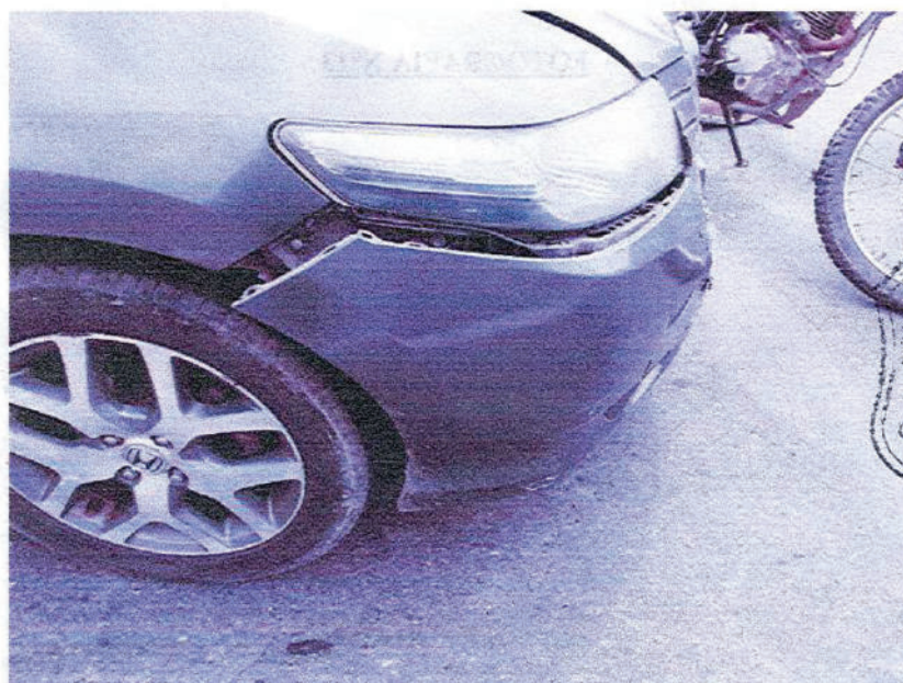
Vista en aproximacion al daño que presenta en el paragolpes,lateral derecho del automovil-
