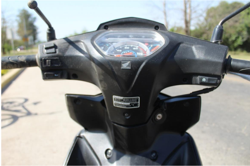
FOTOGRAFIA N° 76: Detalle de tablero y tambor de encendido de la motocicleta.
