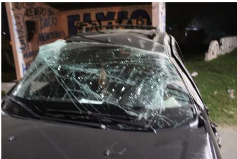
Fotografía n°28: En aproximación al parabrisa delantero de la camioneta donde se observa daños. -
