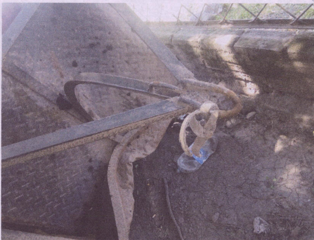
Toma fotográfica donde se observa la lanza de acople o enganche y los daños en su panel fronta
