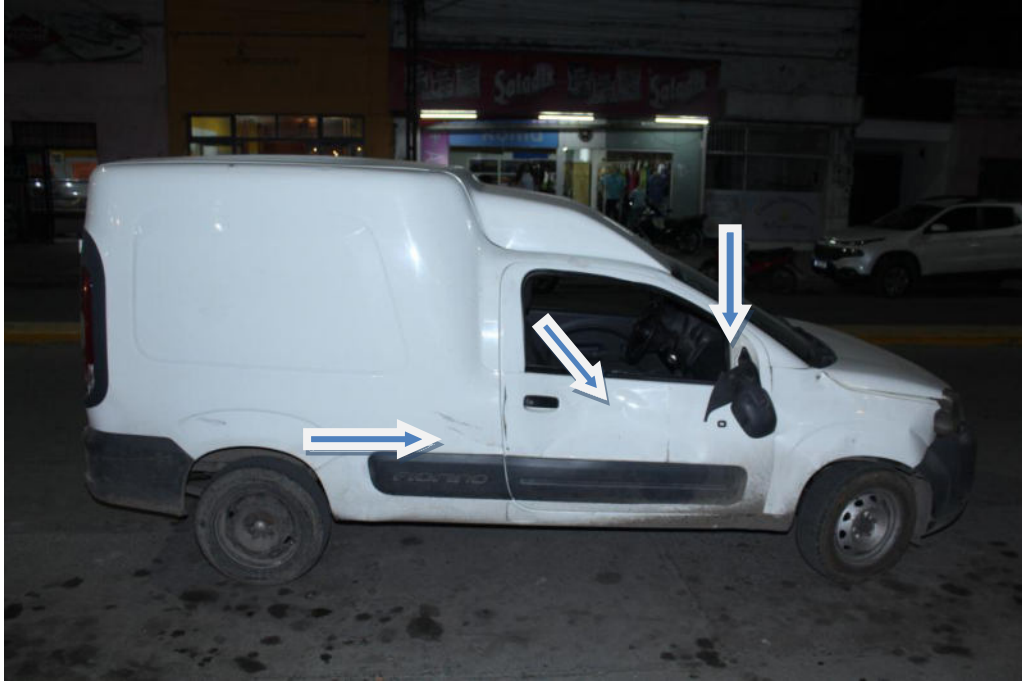
FOTOGRAFIA N° 14: Toma realizada al lateral derecho de la camioneta en mención, se observa daño, índico con flecha inserta.-
