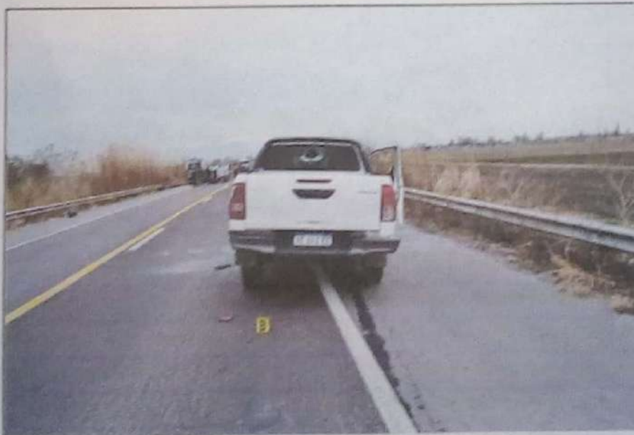
Fotografía n°69: Se observa marca de neumático, mancha oscura y parte posterior de la camioneta, como así también daños en luneta.-
