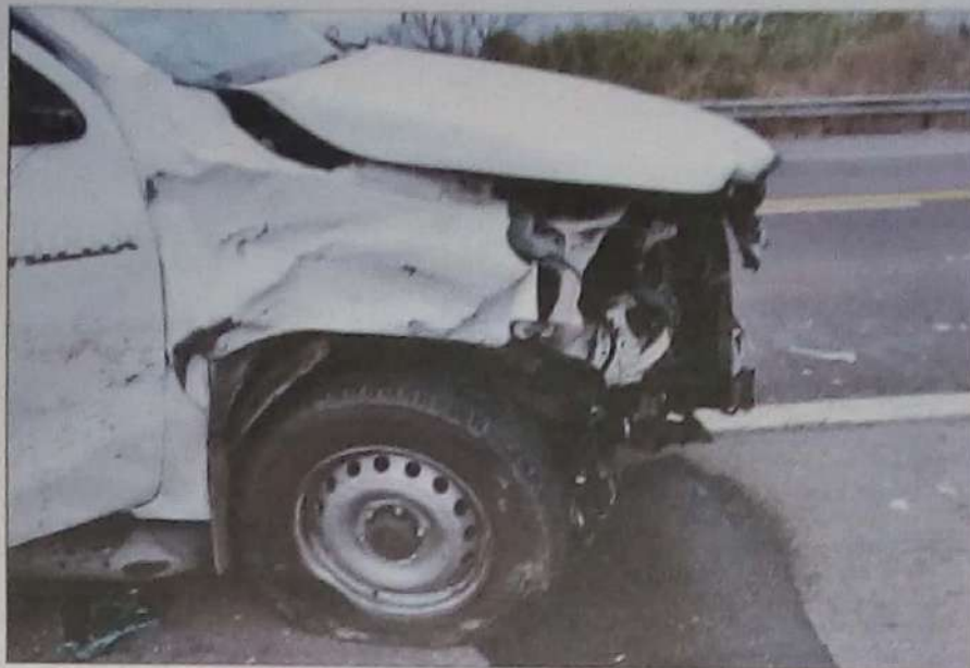
Fotografía n°82: Se observa daños en rueda delantera derecha y restos biológicos en puerta delantera.-
