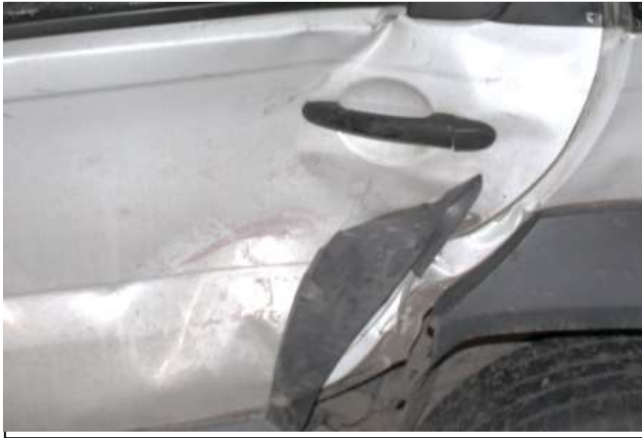
Fotografía n°17: Toma realizada a pintura adherida en puerta trasera mismo lateral.-
