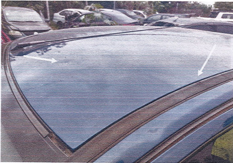
FOTOGRAFIA N ° 14: Toma donde se observa pequeña abolladura en el techo del vehículo en mención en su parte media delantera y marcas de fricción de color oscuro en su lateral izquierdo parte media. Ambos indicados con flecha insertas.-
