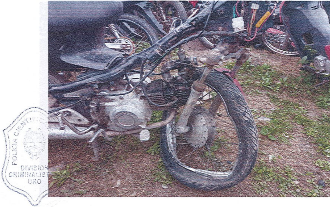
FOTOGRAFIA N ° 6: Toma realizada en detalle donde se observa: Llanta delantera torcida con deformaciones en toda su extensión con desplazamiento hacia la derecha hacia adentro.- Cubierta delantera desinflada (sin aire). Barrales delanteros con desplazamiento hacia atrás y hacia la derecha.-
