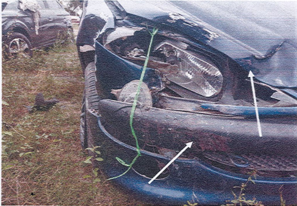
FOTOGRAFIA N ° 10: Toma en detalle donde se observa extremo derecho del paragolpes delantero con adherencia de pintura de color rojo. Capot con adherencia de pintura de color rojo, ambos indicados con flechas insertas -
