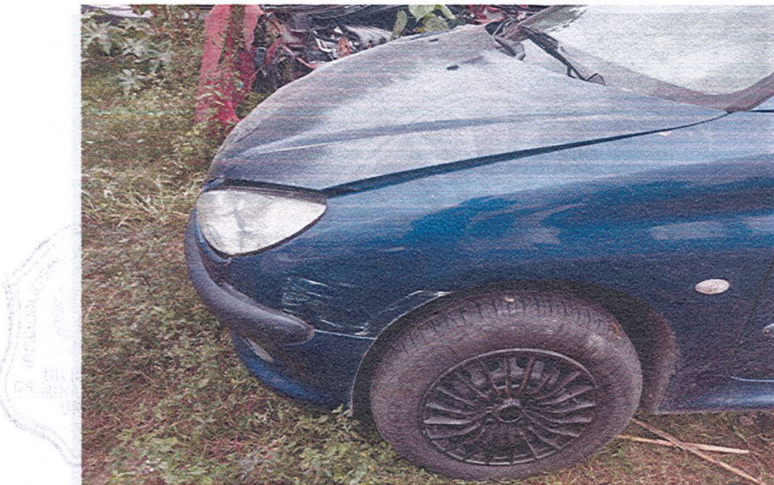
FOTOGRAFIA N ° 13: Toma donde se observa el: Guardabarros delantero izquierdo raspado con adherencia de pintura de color blanco en su extremo delantero y el estado que presenta el mismo.-
