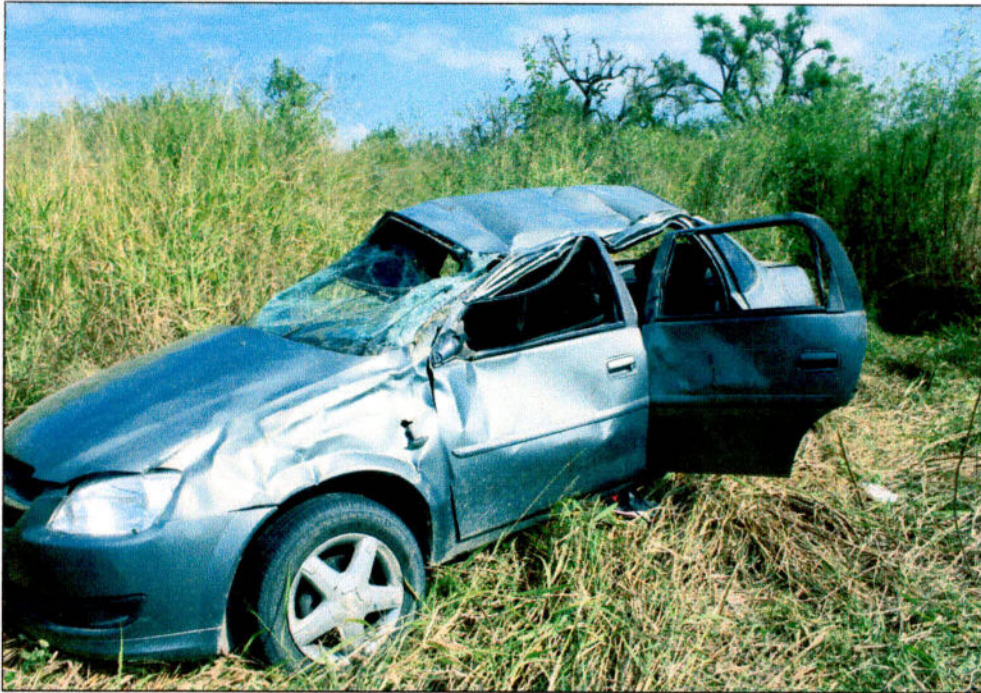
Fotografía n° 24: panorámica del lateral izquierdo del automóvil se observa las deformaciones
