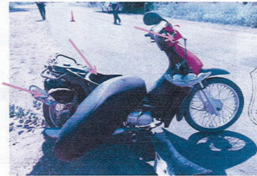
FOTOGRAFIA N° 15: Toma fotográfica realizada a la parte lateral derecho donde se observan daños indicados con flecha inserta.
